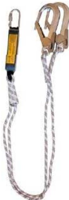
RGL8/L/K1/2XK11 SEIL Y-HALTESEIL Halteseil mit Kernmantelseil ausgestattet mit Schraubverschluß-Karabiner und Falldämpfer an einer Seite und automatischem Anlegehaken auf der anderen Seite Gemäß Norm: EN354 / EN355 Länge: 1,3m / 1,8m (L) Farbe: weiss/rot Euro 75,00
