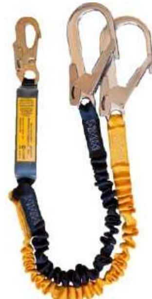
RGL9/L/K10/2XK11 ELASTISCHES Y-HALTESEIL Halteseil aus elastischem Bandgewebe, ausgestattet mit automatischem Haken, Falldämpfer an einer Seite und automatischem Anlegehaken an der anderen Seite, 2 Farben für extra Sicherheit Gemäß Norm: EN354 / EN355 Länge: 1,3m / 1,8m (L) Farbe: gelb/schwarz Euro 85,00
