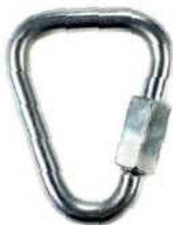
RGK12 STEEL-DELTARING Deltaring aus Stahl mit Schraubverschluß Gemäß Norm: EN362 Mindest Bruchkraft: 22 kN Euro 1,80
