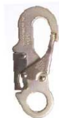
RGK10 STAHL-AUTOHAKEN Automatischer Haken aus Stahl Gemäß Norm: EN362 Mindest Bruchkraft: 27 kN Euro 7,00
