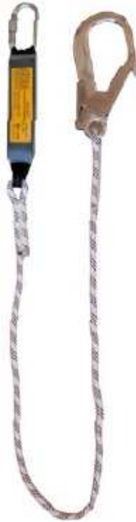
RGL1/L/K1/K11 SEIL HALTESEIL Halteseil mit Kernmantelseil ausgestattet mit Schraubverschluß-Karabiner und Falldämpfer an einer Seite und automatischem Anlegehaken auf der anderen Seite Gemäß Norm: EN354 / EN355 Länge: 1,3m / 1,8m (L) Farbe: weiss/rot Euro 47,50
