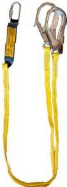
RGL3/L/K1/2XK11 BAND Y-HALTESEIL Halteseil mit Kernmantelseil ausgestattet mit Schraubverschluß-Karabiner und Falldämpfer an einer Seite und automatischem Anlegehaken auf der anderen Seite Gemäß Norm: EN354 / EN355 Länge: 1,3m / 1,8m (L) Farbe: gelb Euro 67,00
